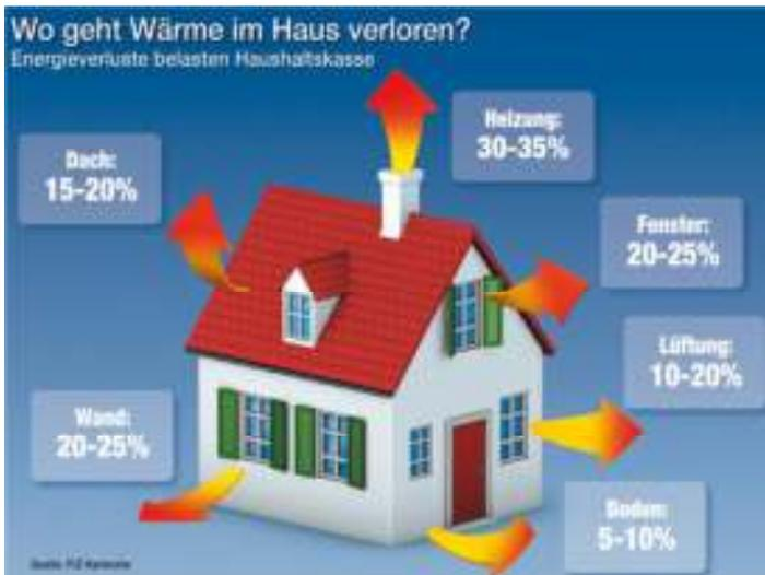
Abbildung 6: Wärmeverluste im Einfamilienhaus mit einem Baujahr vor 1995, Quelle: <https://www.baulinks.de/webplugin/2010/1212.php4>
