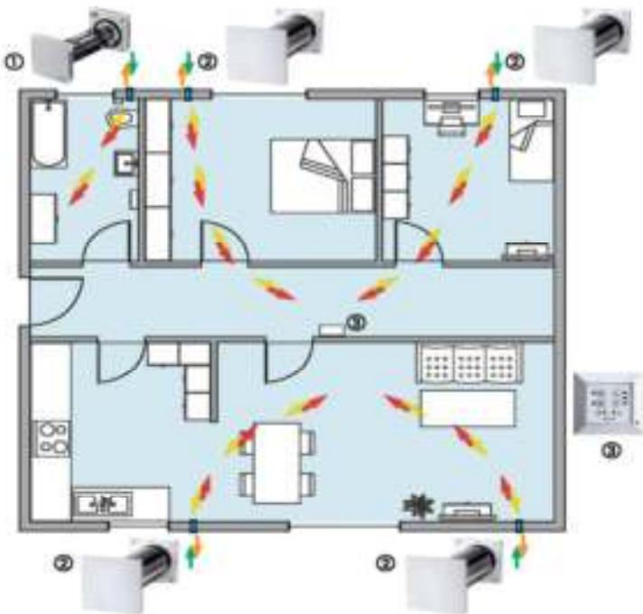
Abbildung 9: Beispiel einer dezentralen Lüftungsanlage, Quelle: [https://www.haustec.de/sites/default/files/styles/content\\_default/public/2020-09/maico\\_kombiloesung-pp-45-mit-ppb-30\\_1.jpg.webp?itok=VsNoXWyg](https://www.haustec.de/sites/default/files/styles/content_default/public/2020-09/maico_kombiloesung-pp-45-mit-ppb-30_1.jpg.webp?itok=VsNoXWyg)
